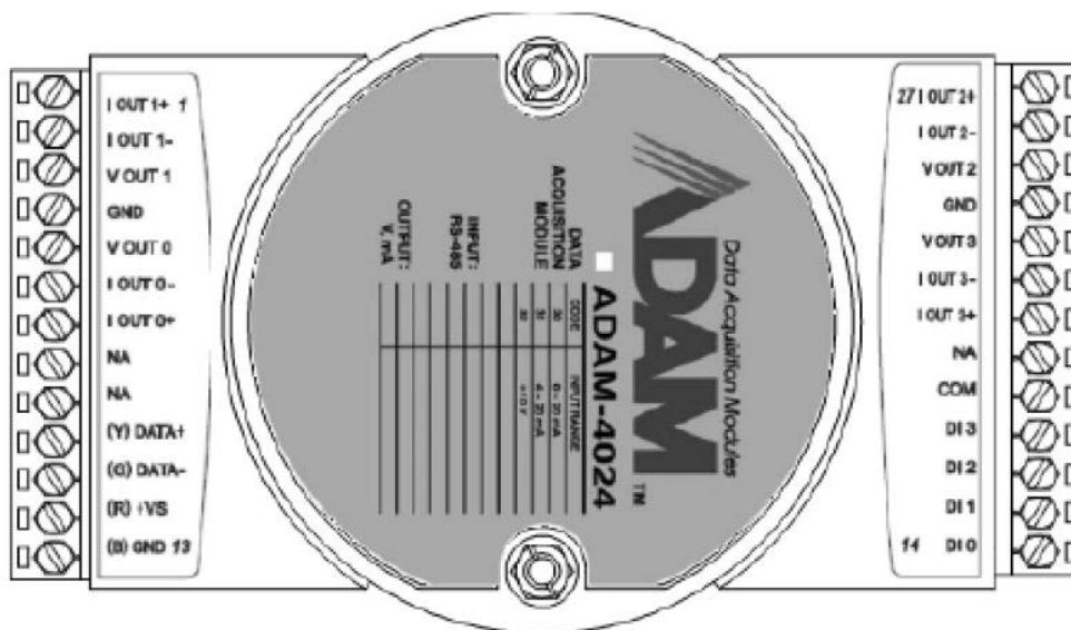
Abbildung 3: Anschlüsse ADAM-4024 Modul
