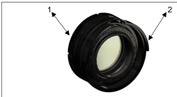
Abbildung 17: Fokussiereinheit (Äußerer und innerer Teil)
