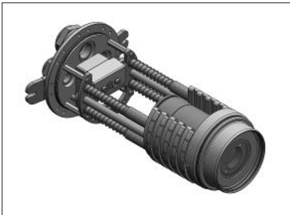
Abbildung 33: Frontaufsatz mit Pyrometer im Chassis
