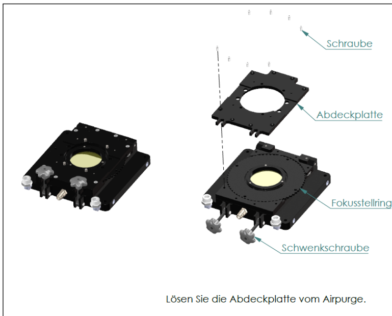
Abbildung 51: Montage des laminaren Freiblasvorsatzes
