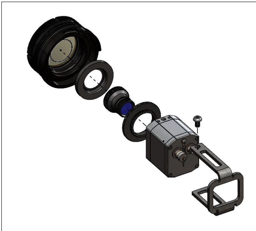
Abbildung 19: Einbau der 80° Optik
