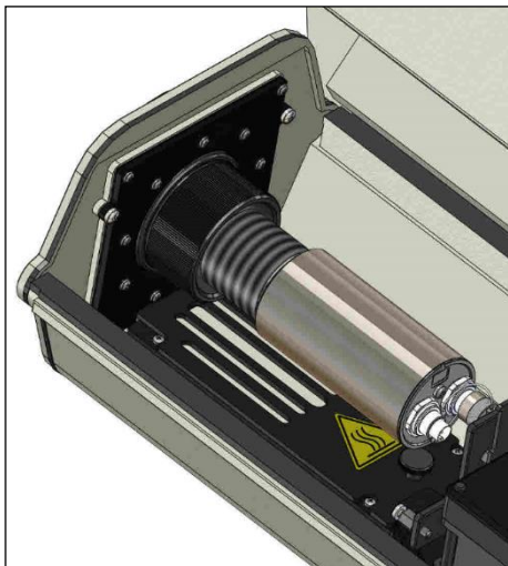
Abbildung 15: Xi Kamera in Adapterplatte schrauben
