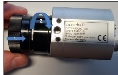
Abbildung 13: Einsetzen des Objektivs
